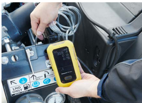
Des détecteurs de gaz mobiles aident à la recherche de fuites de gaz.
